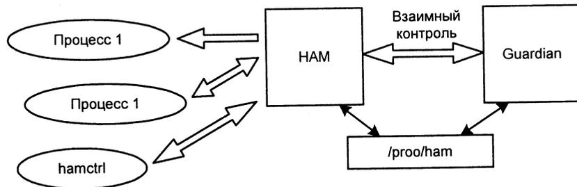
Рис. 15.1. Схема взаимодействия элементов при работе НАМ
