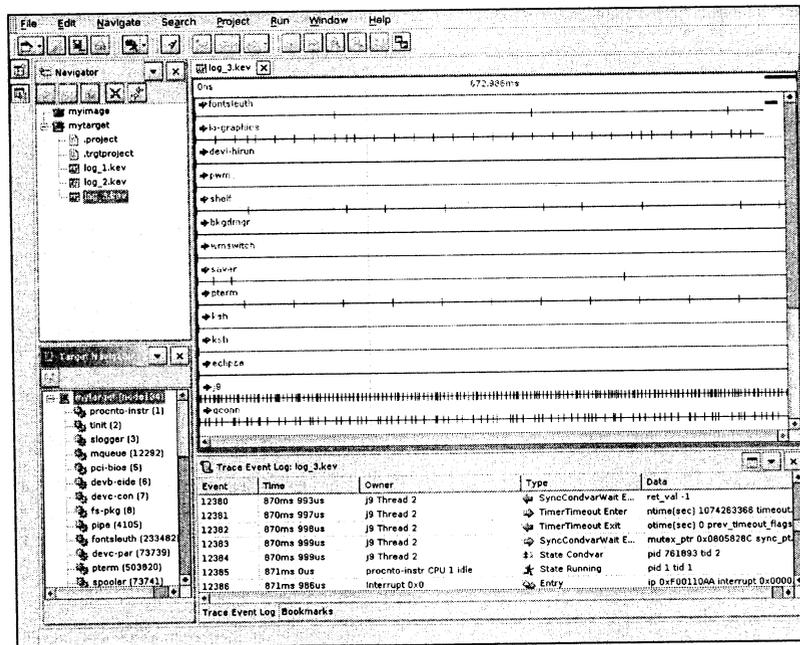
Рис. 14.2. Перспектива QNX System Profiler
